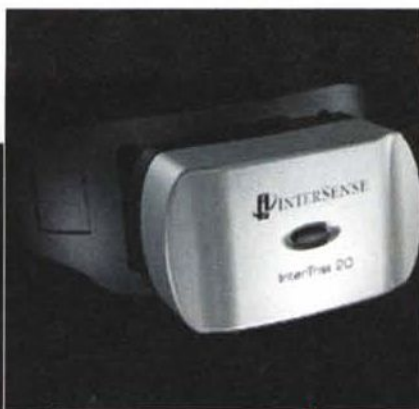
Il sistema di tracciamento della posizione di InterSense è l'Intertrax 20: sensore giroscopico a due gradi di libertà (Azimuth: \pm 180 gradi; Elevation: \pm 80 gradi) è caratterizzato da un refresh rate di 256Hz. La sensibilità massima è di 400 gradi al secondo per l'azimuth e di 360 gradi al secondo per l'elevation. Il tempo di latenza è di circa 38\text{ms} \pm 2 .
